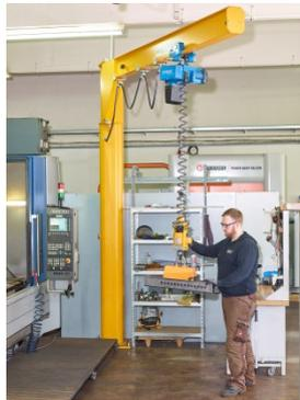
41727-9: Führen und Steuern der Last, die zweite Hand wird lediglich unterstützend eingesetzt.
