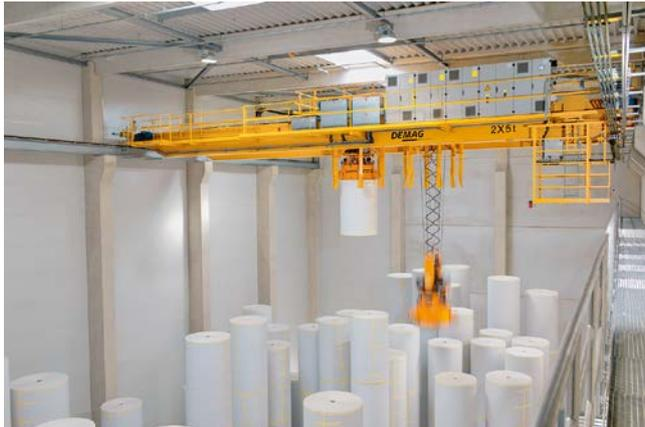
**40290-56:** Hohe Umschlagzyklen werden in dem neuen Lager der Laakirchen Papier auch ermöglicht durch zwei unabhängig voneinander verfahrbare Windwerkkatzen an den beiden Prozesskranen.
