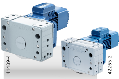
Radblocksysteme DRS-M / DRS: je 4 Baugrößen, Raddurchmesser 112–200 mm (DRS-M) und 250–500 mm, bis 40 t / Rad (DRS)
