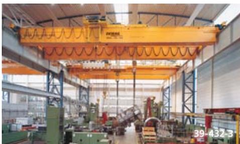
Siemens Mülheim: Prozesskrane mit Wendefunktion für die Produktion von Großturbinen.
